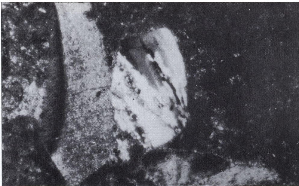
b. Μεγάλο μόριο από στρογγυλεμένο πολυκρυσταλλικό Quartz δίπλα από ένα θρύμμα από όστρακο. Παρατηρείται η μεγάλη ποσότητα από τσιμέντο άμορφου ασβεστίου που εξασφαλίζει μικρότερη πορώδη από εκείνη που παρουσιάζει το δείγμα A (βλ. φωτοδιάγραμμα Fig. 7). Nicols+, 65X.
